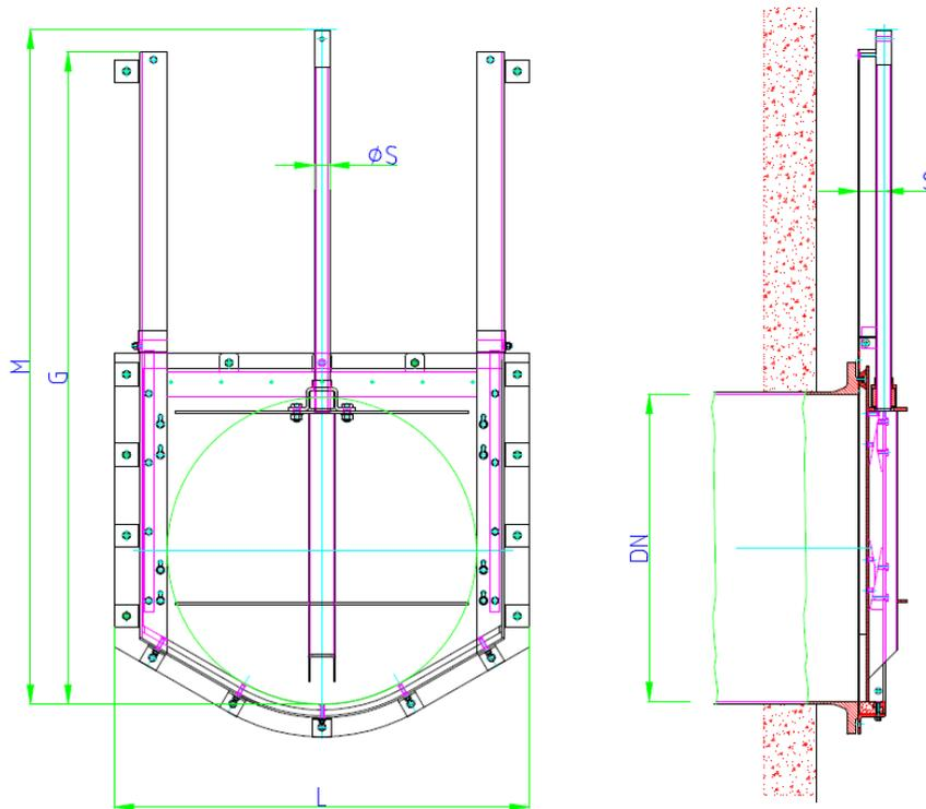
\* passend für bauseitigen Flansch DIN 2501 PN 10
